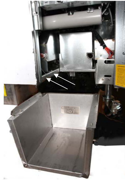
Figura 1: Posición del fusor en el gabinete y se sujetan con tornillos en el interior del gabinete.
