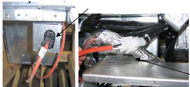
Figura 3: Conecte el conector blanco de dos clavijas y conecte el conector negro en el cuadro de servicios públicos, como se muestra.
